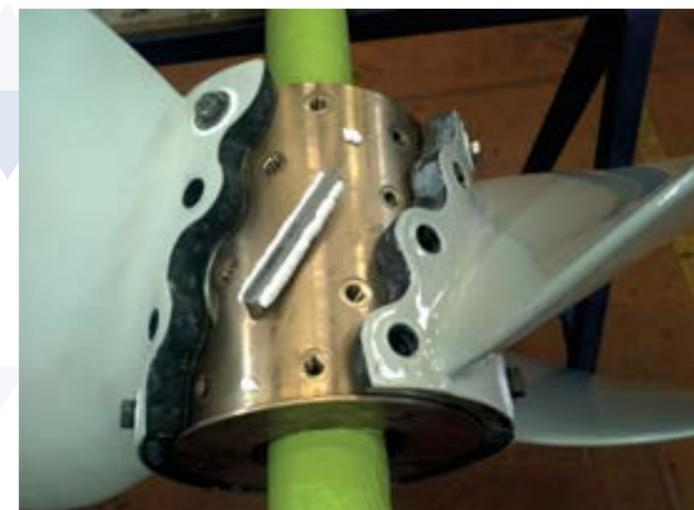
+ Comment fixer solidement des pales en composite sur un moyeu métallique ? Réponse : avec un solide système en créneaux et huit boulons par pale.
